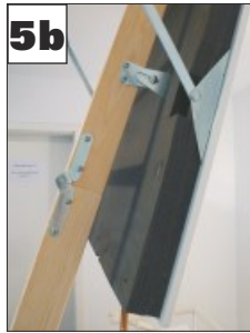
5b: Genaue Höheneinstellung der Treppe: Treppenwangen müssen sauber aufeinander stehen und fluchten. Einstellung (+/- 5 cm) durch Verschieben der Wangen in den Stützen. Wichtig: Immer mit der richtigen Raumhöhe bestellen!
