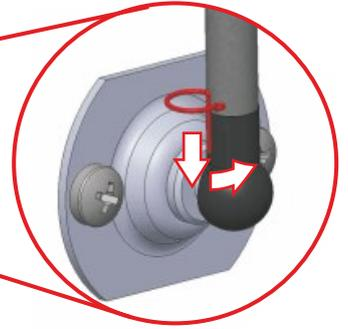
Gegebenenfalls Zusatzstufe(n) montieren.
