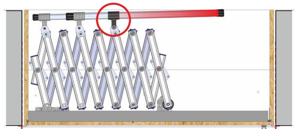
**Handlauf an allen Stützen der Scherentreppe montieren:**
