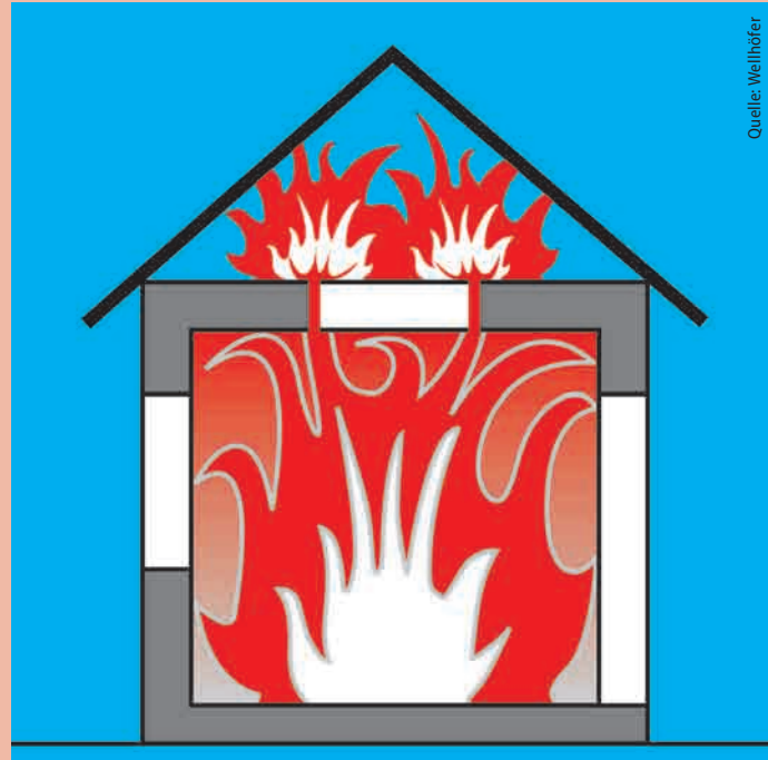
Abb. 4: Gefahrenquelle Einbaufuge – Kamineffekt
