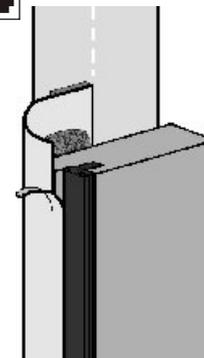
Dichtband vollflächig an den Rahmensteg kleben. Überstehendes Dichtband an der Falzkante bündig schneiden.
